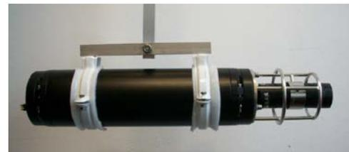
Otra línea de investigación en donde la acústica juega un papel muy importante es en los experimentos de búsqueda directa de materia oscura (un enigma todavía por resolver) como PICO que utiliza un líquido sobrecalentado. La interacción de las partículas con el líquido produce burbujas. Para optimizar la medida de la señal acústica generada en la cámara de burbujas se adhiere un transductor piezoeléctrico a la pared exterior de cuarzo.
