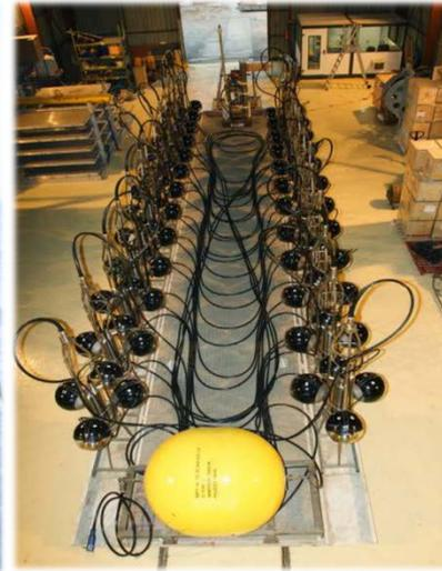
Imágenes centro y derecha: se muestra el despliegue de una línea completa con 12 líneas con 12 pisos del telescopio.
