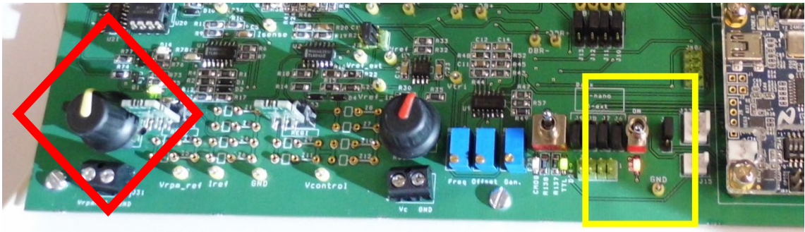
Figura 3. Posición de la palanca de habilitación de disparos (recuadro amarillo) y del potenciómetro que programa la velocidad de giro del motor (rombo rojo).
