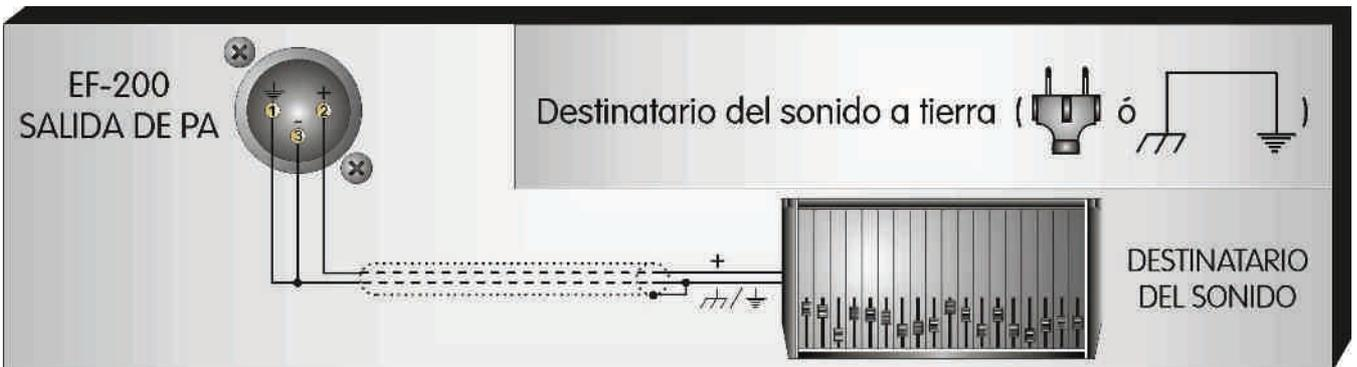
2) Usando cable de un conductor más pantalla:
