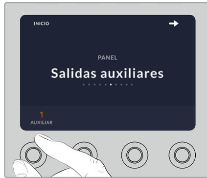
Gire el mando a fin de asignar una salida auxiliar para controlar la cámara.
