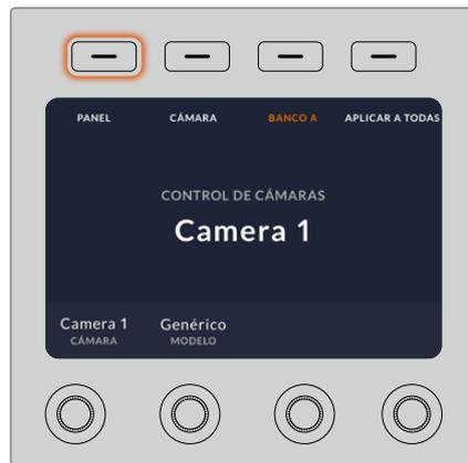
Presione el botón **AJUSTES** en la pantalla de inicio para acceder a los distintos parámetros de configuración del panel.
