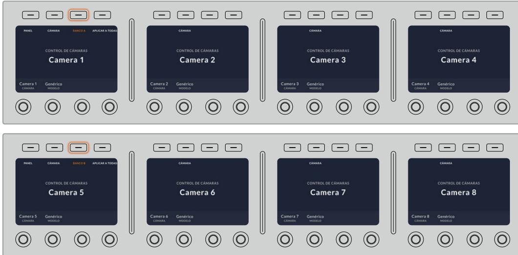
La configuración de bancos permite asignar dos grupos de cámaras a los cuatro módulos y luego alternar de forma inmediata entre ellos presionando el botón **BANCO A/B**.
