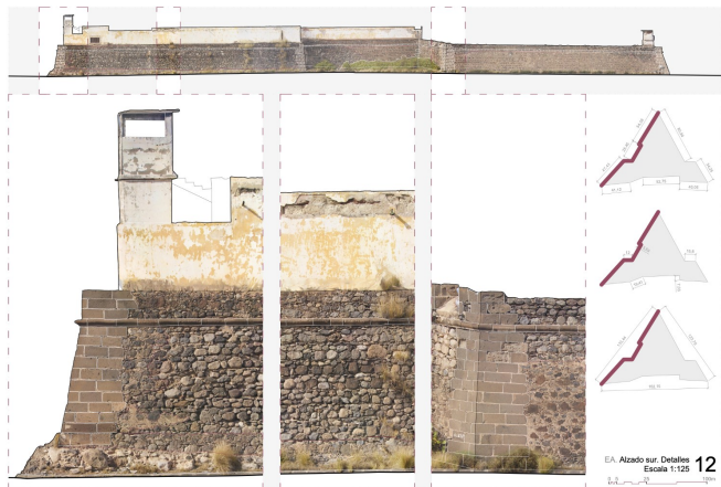
Imagen 9. Levantamiento gráfico. Fotogrametría Alzado sur. Elaboración propia.
