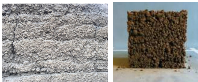
Imagen 3. Izquierda, textura interior de un muro de tierra modelada sin el acabado final. Derecha: Imagen guía del test Carazas para muestras de tierra en estado plástico solamente vertidas en el molde sin compactación alguna.
