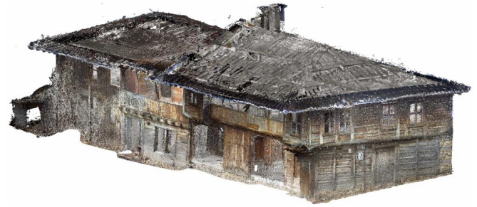
Imagen 4, escaner láser de las casas Kozichkovi.
