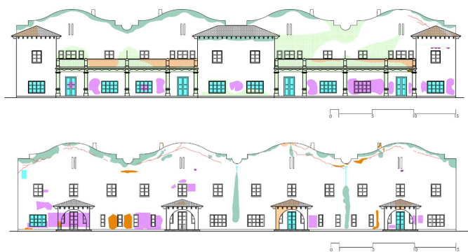
Imagen 4. Alzado frontal y posterior del bloque A con identificación de lesiones. Fuente: Elaboración propia a partir de galería personal de fotografías de H. Quintanilla (2023) y Cormano (2014).
