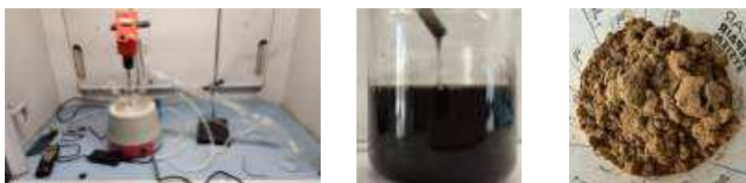
Figura 2. Montaje de reciclado químico de PU a escala laboratorio (izq). Productos obtenidos: r-poliol (centro) y residuo de PES (der).
