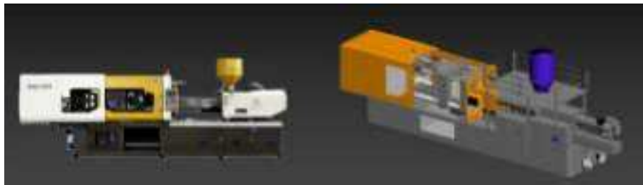
Figura 2. Comparativa entre el modelo real de la inyectora y el modelo 3d creado, a la derecha.
