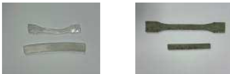
Figura 6. Matriz de SEBS sin aditivar (izq) y aditivada (der) con las fibras de PES recuperadas
