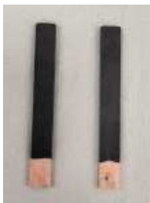
Figura 4. Parte delanteras de las probetas procesadas estáticamente (1) y en movimiento (2).
