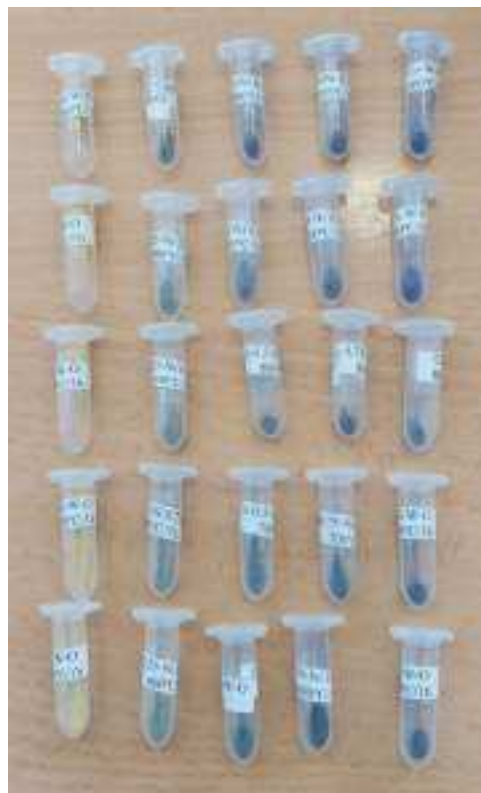
Figura 2. Cinco muestras de la solución sólida \text{Ni}_{1-x}\text{Co}_x\text{WO}_4 , con valores de x = 0, 0.25, 0.50, 0.75 a 600^\circ\text{C} , 700^\circ\text{C} , 800^\circ\text{C} , 900^\circ\text{C} y 1000^\circ\text{C} de abajo a arriba, respectivamente.
