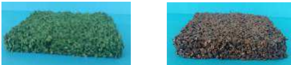
Figura 5. Pavimentos obtenidos tras aglomerado de caucho particulado con sistema PU virgen (izq) r-PU (der).
