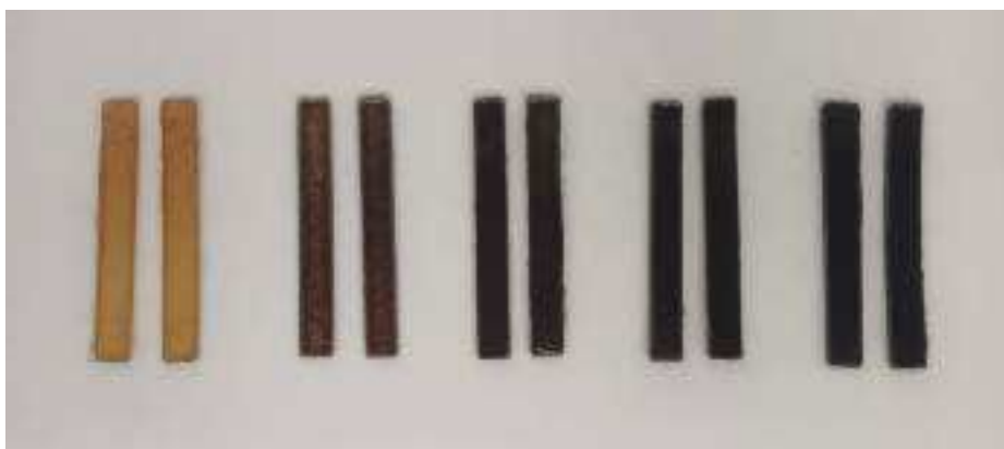
Figura 3. Probetas obtenidas tras el proceso de curado con diferentes contenidos de cáscara de cáñamo (FHO). De izquierda a derecha muestras con el 0, 5, 10, 15 y 20% de carga.
