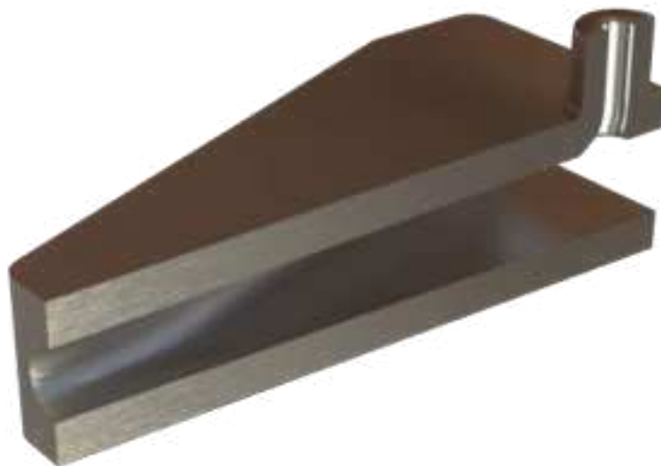
Figura 1. Diseño de la boquilla, con plano de corte longitudinal.
