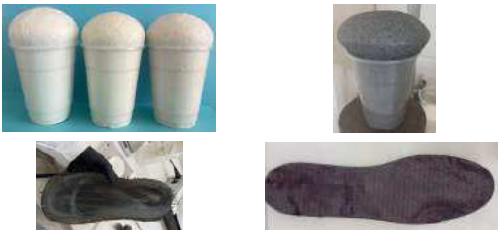
Figura 4. Espumación libre de r-PUF (sup) y fabricación de suelas y plantillas de calzado a partir de ésta (inf).
