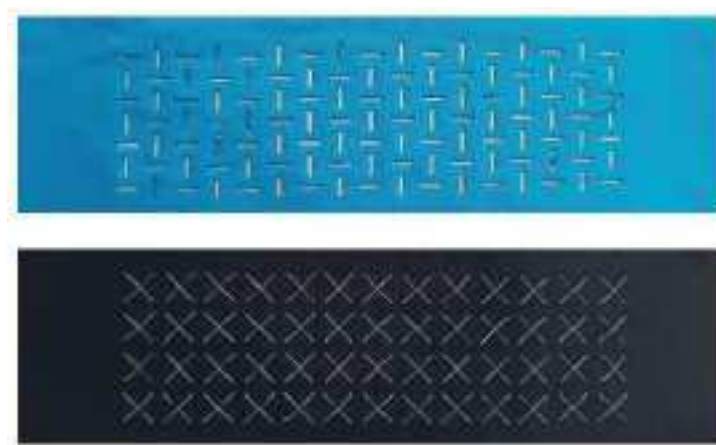
Figura 3. Muestras textiles con geometría de corte auxético reentrante tipo “X” y rotatoria “-”, preparadas para los ensayos.
