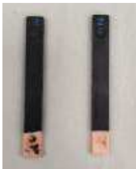
Figura 3. Parte delanteras de las probetas procesadas estáticamente (1) y en movimiento (2).
