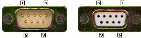
Figura 4-2. Conectores macho y hembra tipo DB-9
