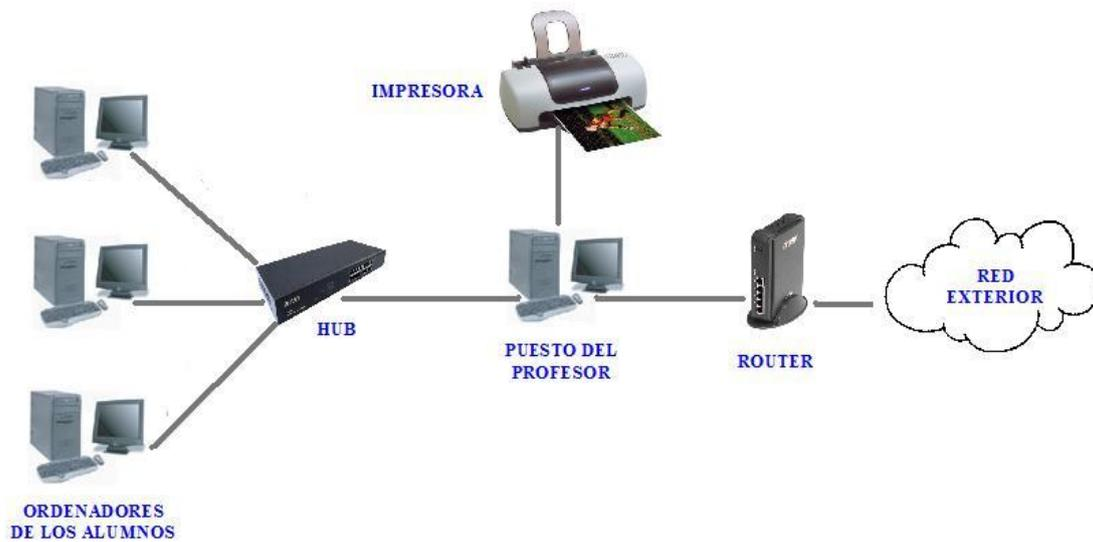
**Figura 5.18.** Configuración hardware de las aulas informáticas.
