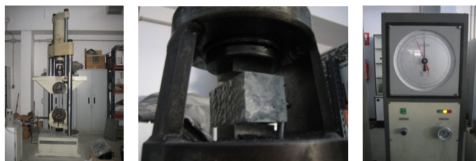
Fig. 3.55 – Ensayo de compresión
