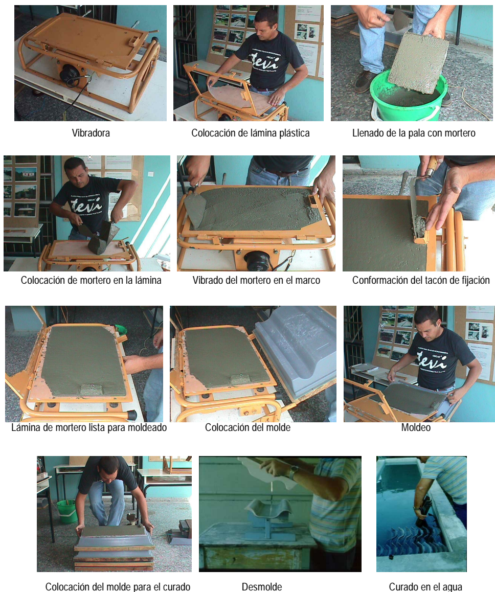
Fig. 1.11 – Fabricación teja microconcreto
