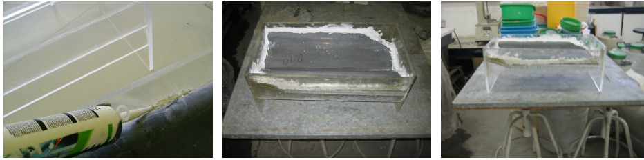
Fig. 3.66 – Ensayo de impermeabilidad
