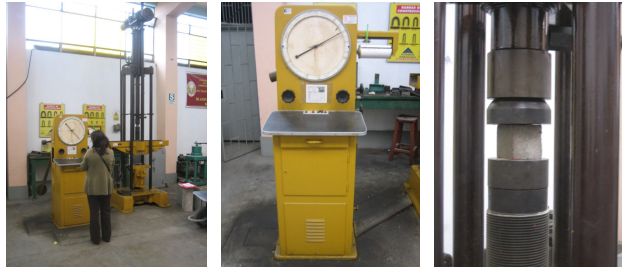
Fig. 3.60 – Ensayo de compresión
