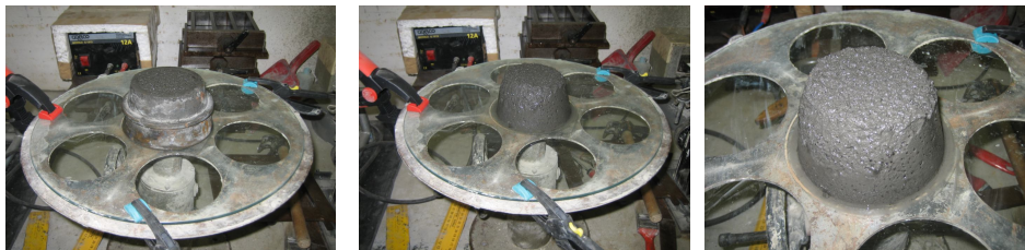
Fig. 3.47 – Mortero antes de sacudidas
