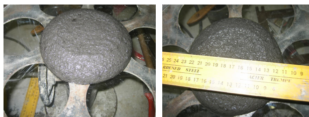
Fig. 3.48 – Mortero tras sacudidas y medida de diámetros
