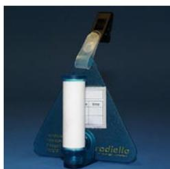
Figura 3. Captador pasivo Radiello montado (R&P-Co, 2001)
