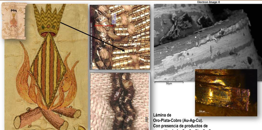
Lámina de Oro-Plata-Cobre (Au-Ag-Cu).
