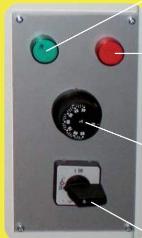
Pilotos de encendido con termostato
