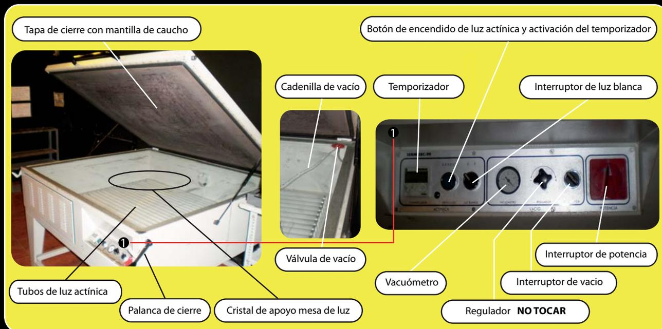
1. Abrir la tapa-mantilla de caucho y la palanca de fijación de cierre. Activa el interruptor de potencia y enciende la luz blanca como mesa de luz.
