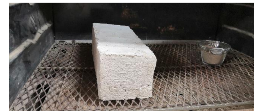
Imagen 8. Tabicones de concreto reciclado. Autoría propia / Image 8. Recycled concrete partitions. Own authorship.
