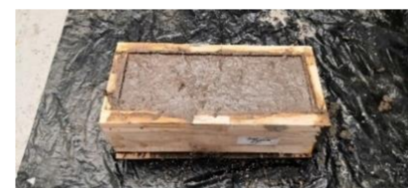
Imagen 7. Fabricación de tabicones de concreto reciclado. Autoría propia / Image 7. Manufacture of recycled concrete partitions. Own authorship.
