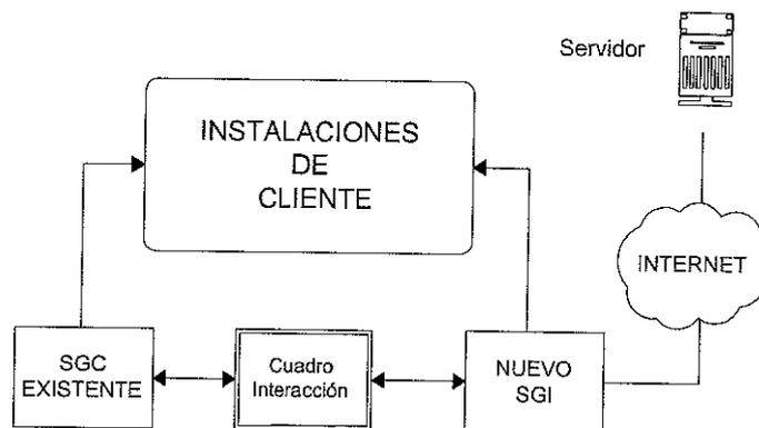
Siendo SGC el sistema domótico (sistema de control de instalaciones existente en el edificio) y SGI (sistema de gestión integral) el del control de consumo eléctrico.
