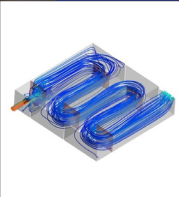
Modelación con CFD del flujo de agua en un depósito.
