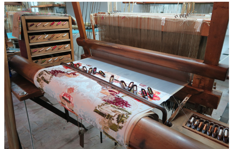
Teler tipus Jacquard. Fàbrica Garín de Montcada (València) Imatge cedida per Ricardo Franch
