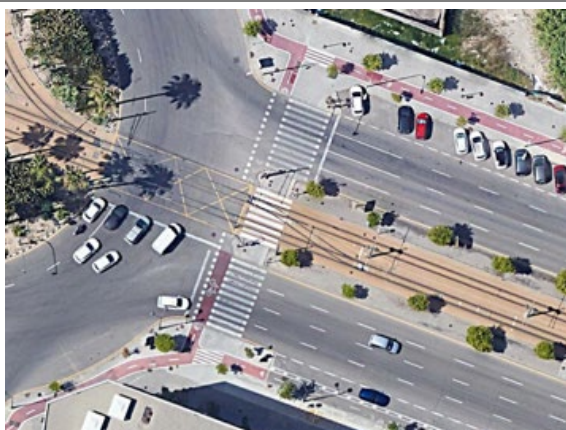
Paso de peatones (nº 11). Paso de peatones en tres tramos que cruzan la calzada y la vía del tranvía, regulación semafórica. Señalización horizontal adecuada en todos los tramos. Sin embargo, isleta intermedia sin protección para los peatones que esperan. Conexión continua de las aceras a ambos lados de la Av. de los Naranjos (en rotonda).
