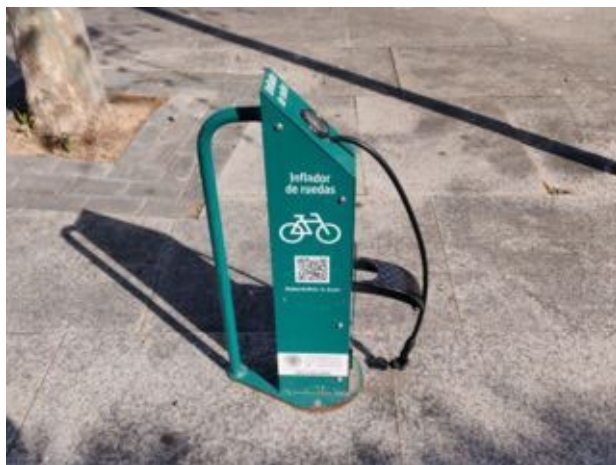
Inflador 3: Adaptador de boquilla inexistente
