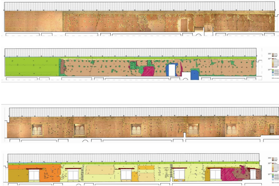
Estudio estratigráfico constructivo de la Galería de Levante del Patio de los Arrayanes de la Alhambra de Granada
