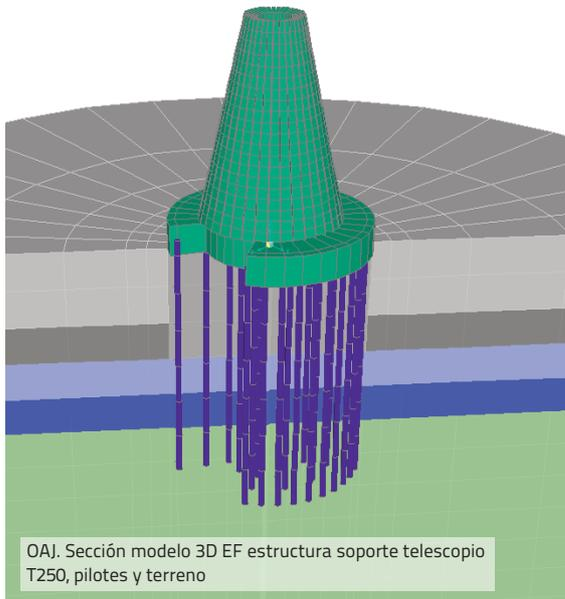
OAJ. Sección modelo 3D EF estructura soporte telescopio T250, pilotes y terreno
