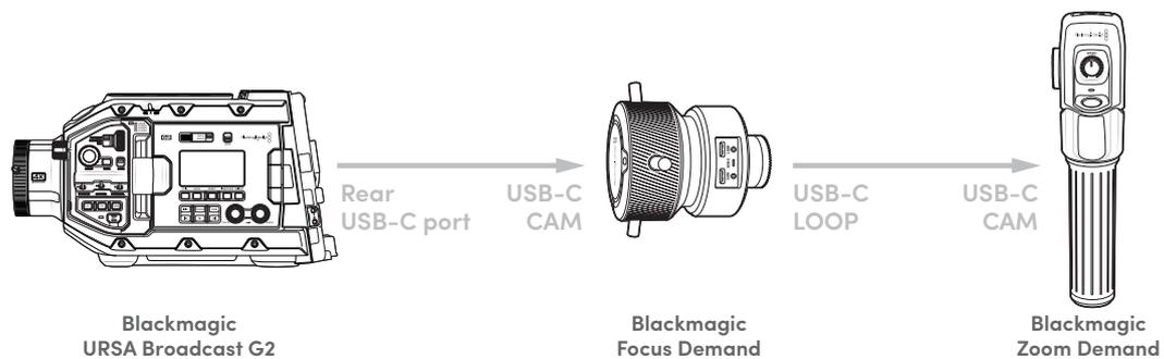
Al conectar ambas unidades en serie, pueden controlarse mediante el puerto USB-C trasero de la cámara. Por ejemplo, conecte un extremo de un cable USB-C a cualquier puerto correspondiente de la cámara y el otro extremo a la entrada **CAM** del dispositivo Blackmagic Focus Demand. Con un segundo cable, conecte la salida de dicho accesorio a la entrada respectiva en la unidad Blackmagic Zoom Demand.
