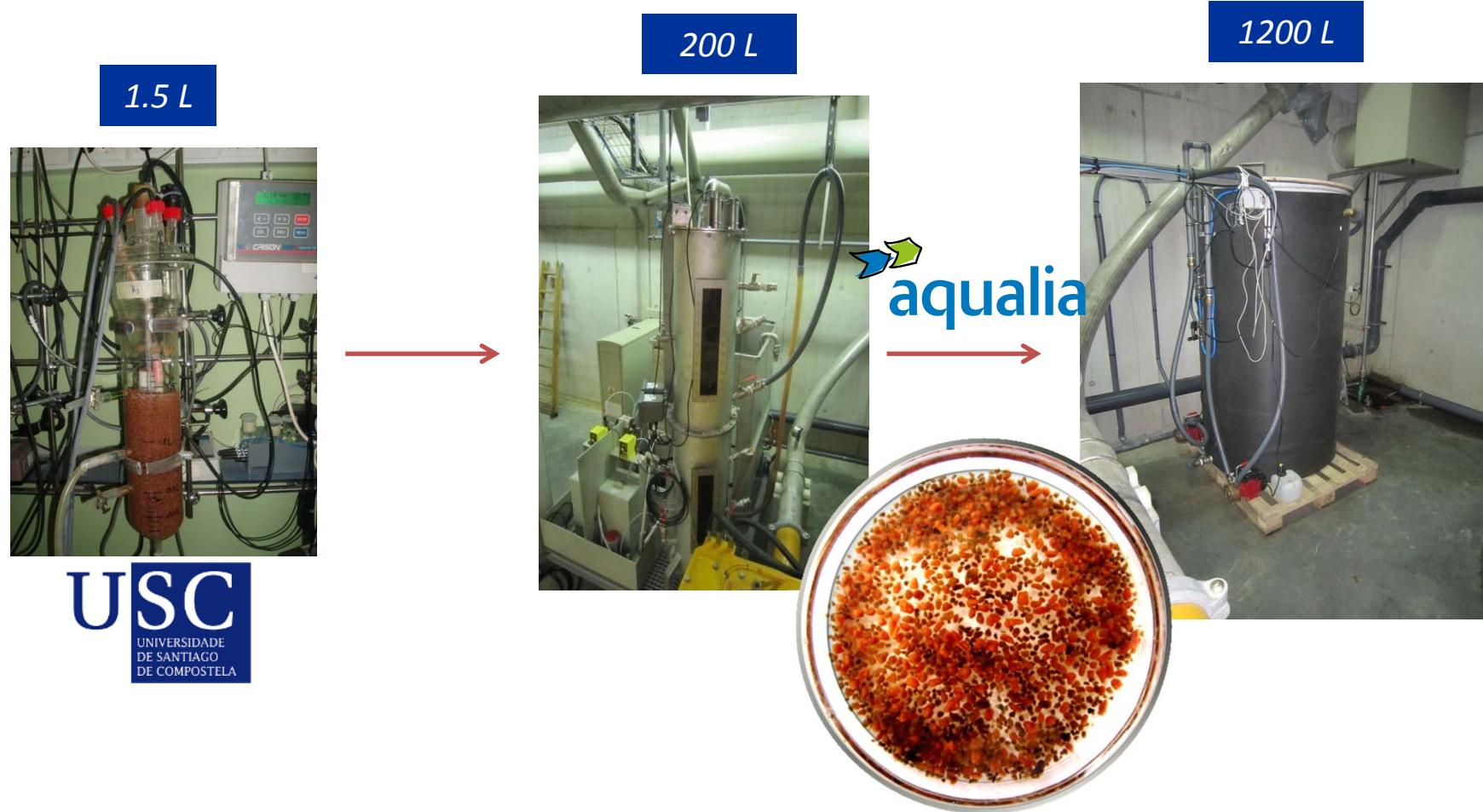
\*ELAN® process (ELiminación Autótrofa de Nitrógeno): combination of partial nitrification and Anammox in a single reactor.
