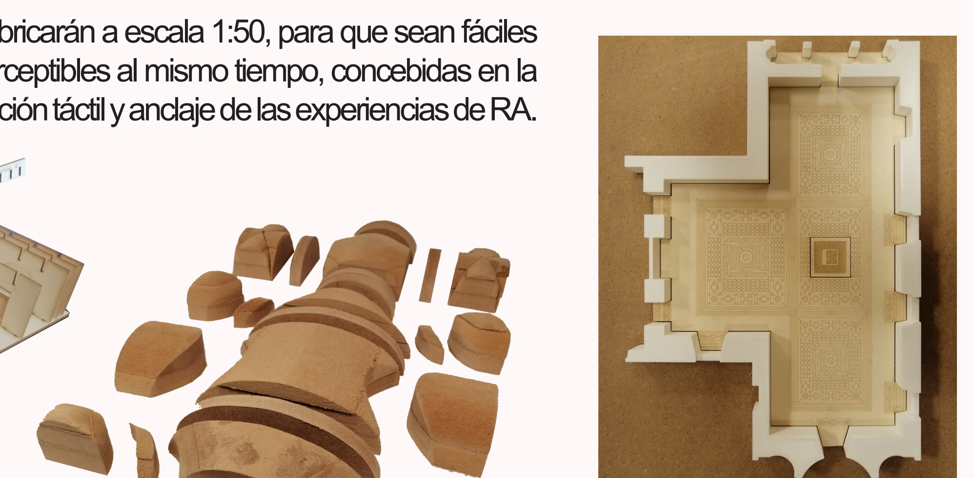
Fig. 11. MAO, bóvedas del atrio - modelo conceptual de MDF: fresadora CNC Biemmepe - FP3 (F. Ronco). Los huecos se han convertido en sólidos.
