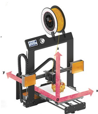
Ilustración 15. Ejes cartesianos de impresora 3D. Fuente www.diwo.bq.com
