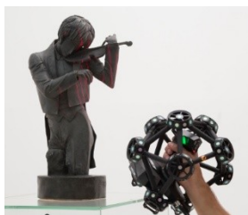
Ilustración 6. Proceso de escaneo 3D con un láser escáner manual. Fuente www.blog.museunacion.cat
