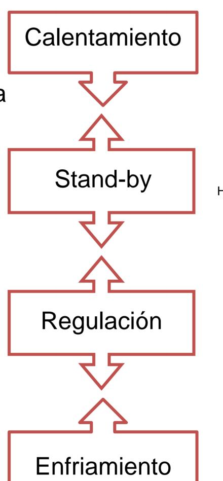
El sistema de recuperación opera en cuatro etapas diferentes según la temperatura de admisión y del refrigerante.
