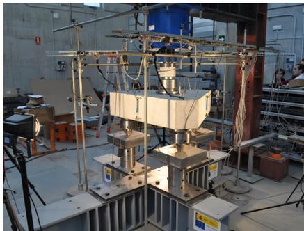
Montaje de los ensayos de la serie 1
