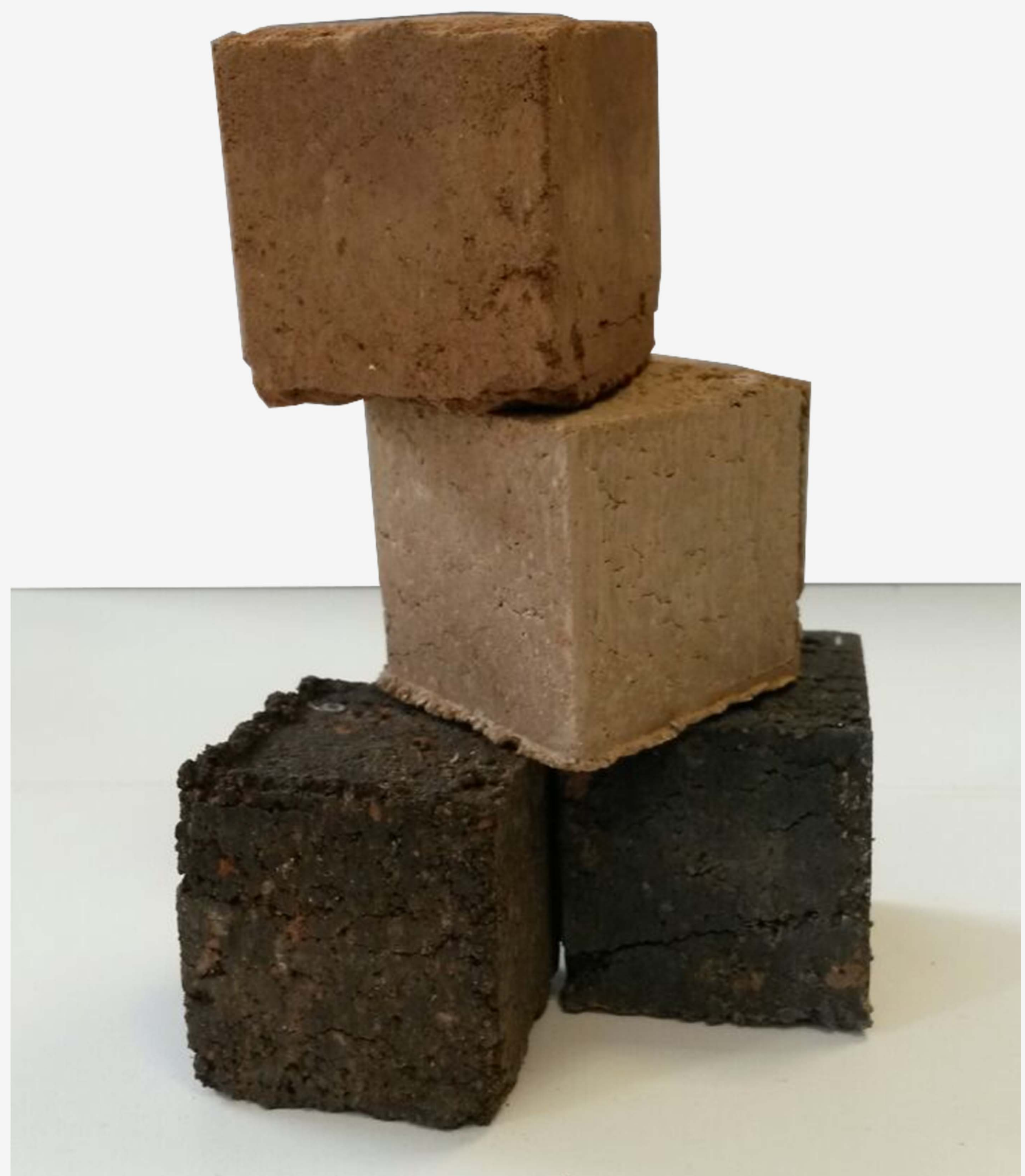
Probetas de 40x40x40 mm suelo-cemento y suelo-geopolímero
