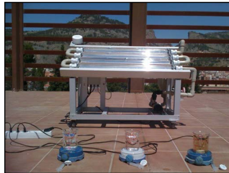
Imagen 2 Planta piloto de detoxificación solar de 4 litros
