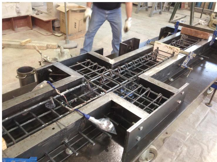
Figura 4.2: Encofrado de la probeta de hormigón.
