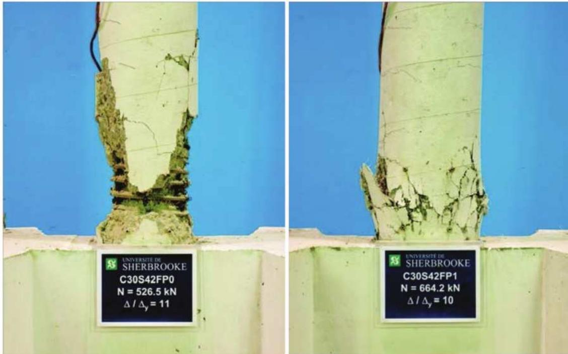
Figura 2.41: Fotos de rotura de probetas. Fuente: Mier et al. 2013, [8]
