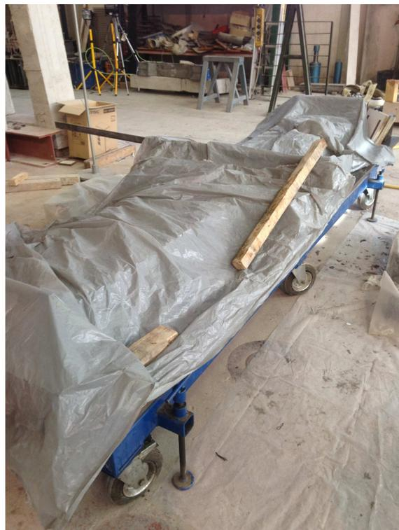
Figura 4.21: Probeta cubierta con plástico para asegurar el curado.
