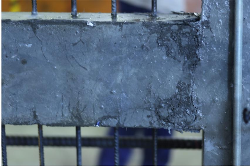
Figura 5.2: Ejemplo 1 efecto stub. ENS-3/10/T-I
