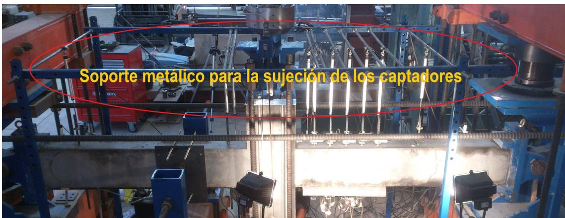
Figura 4.24: Soporte metálico para la sujeción de los captadores.
