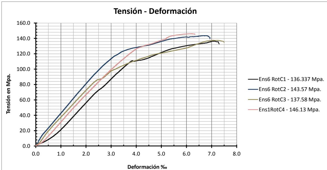
Figura A.18: Resistencia a compresión ensayo 6 probetas cúbicas.
