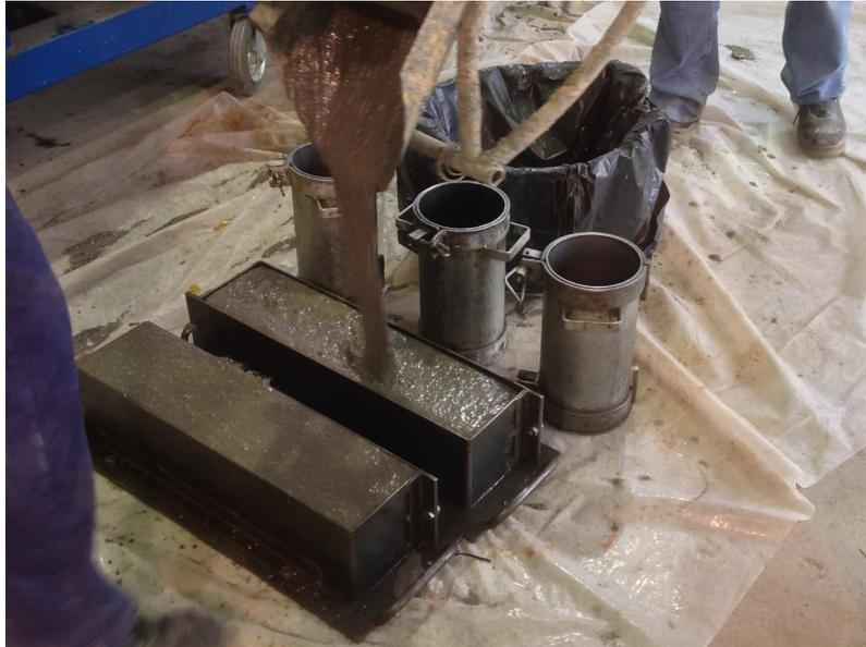
Figura 4.22: Hormigonado de las probetas de control.
