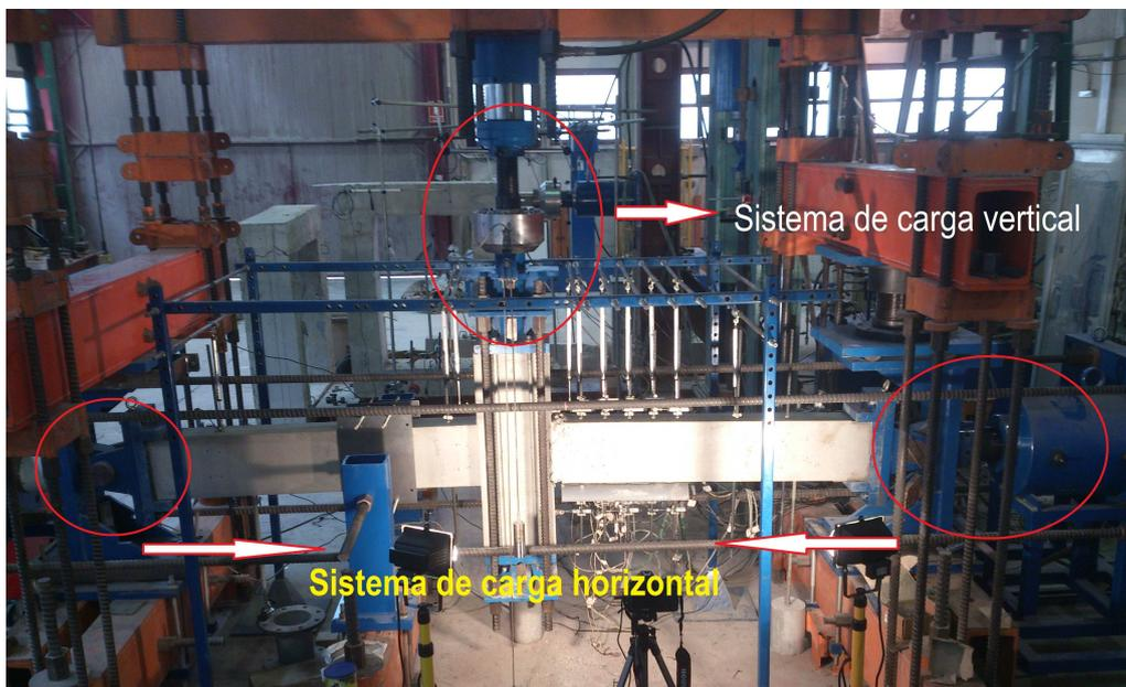
Figura 4.11: Pórtico de ensayo.
