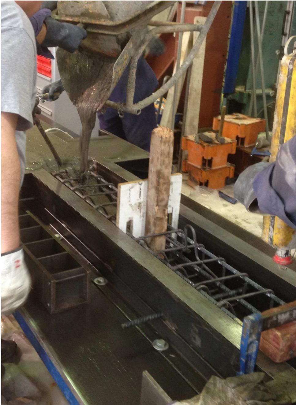
Figura 4.19: Vertido del hormigón de la amasada 1.
