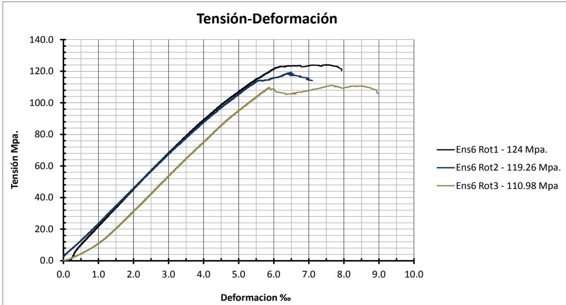
Figura A.17: Resistencia a compresión ensayo 6 probetas cilíndricas.
