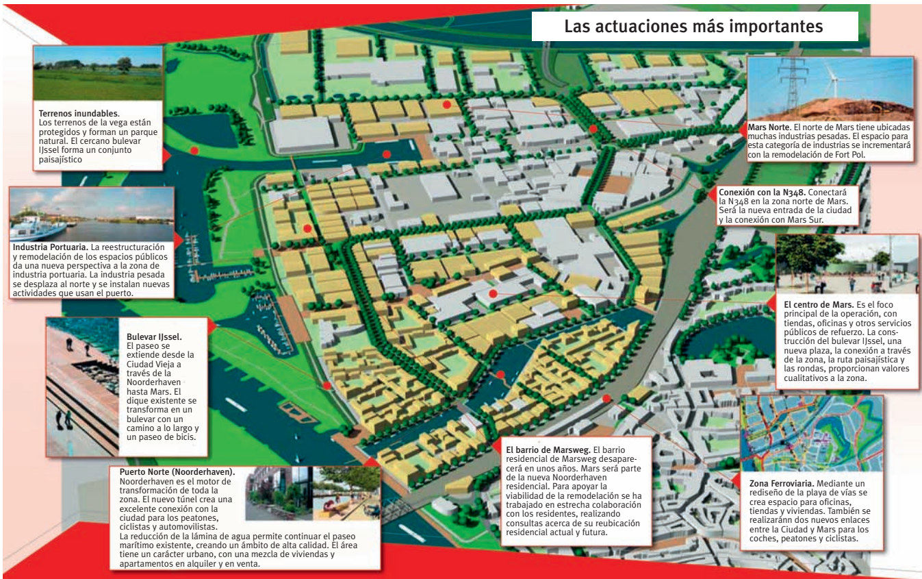
FIGURA 6. ESQUEMA DEL PROYECTO DE REGENERACIÓN DEL ÁREA INDUSTRIAL DE MARS EN HOLANDA
