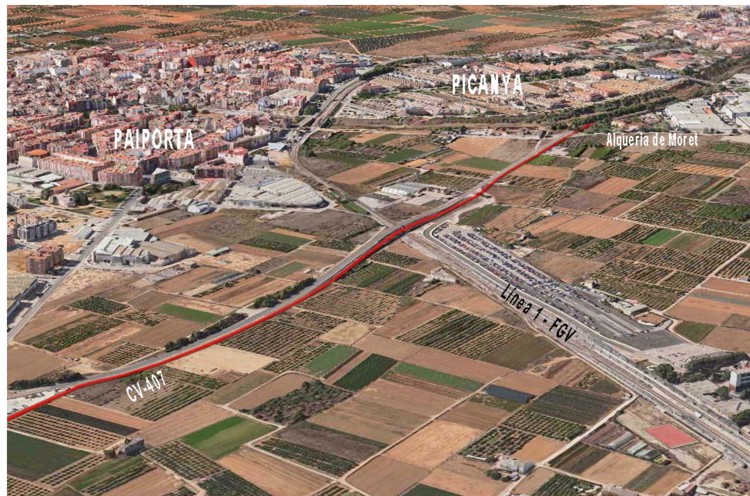
Vista desde el norte (Este – oeste): Trazados propuestos por el lado norte de la CV-407 y pasarela sobre las líneas de FGV hasta Travessera de la Diputació (T.M. de Picanya).
