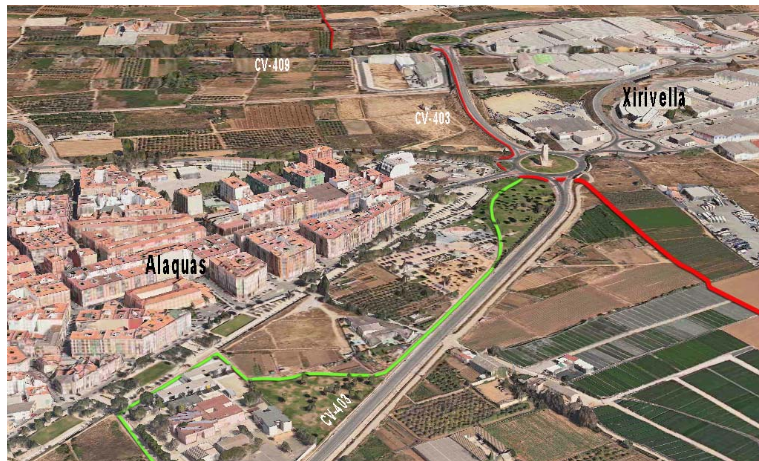
Vista desde el sur (Sur – norte): Trazados propuestos desde la línea del AVE a la rotonda de Alaquàs, y al fondo el paso superior de la CV-403 para enlazar con la CV-409.
