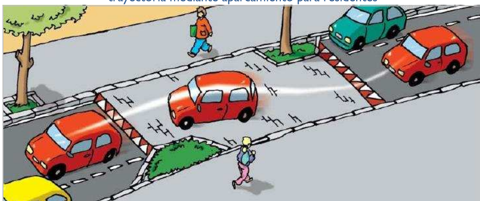
Ilustración 7 Medidas de calmado del tráfico en áreas 30. Chicanes de desviación de trayectoria mediante aparcamiento para residentes
