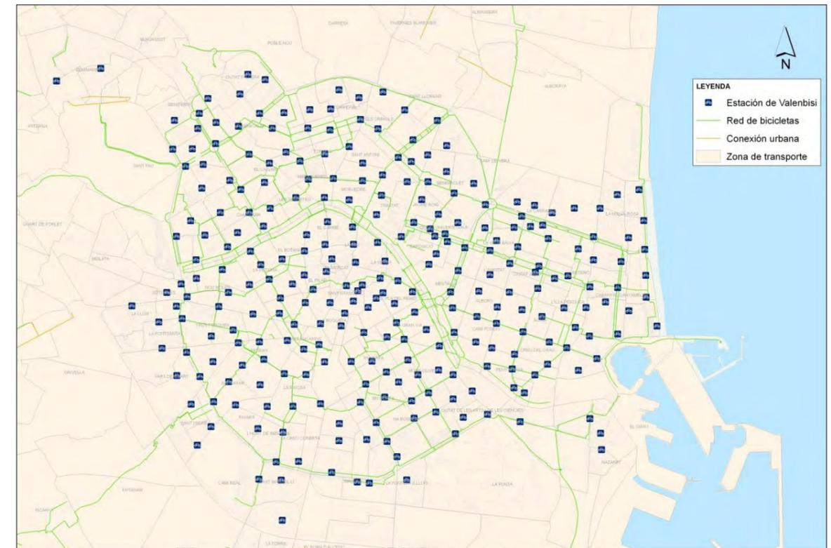
La empresa JCDecaux tiene implantando su sistema Cyclocity con el nombre de Valenbisi. Cyclocity es un sistema automático en el que el usuario opera a través de una tarjeta magnética (móvilis). Cada bicicleta está sujeta a un anclaje que a su vez está conectado a la terminal de acceso al servicio (lector de tarjeta). El sistema se estrenó en Viena (Austria) en el año 2002.
