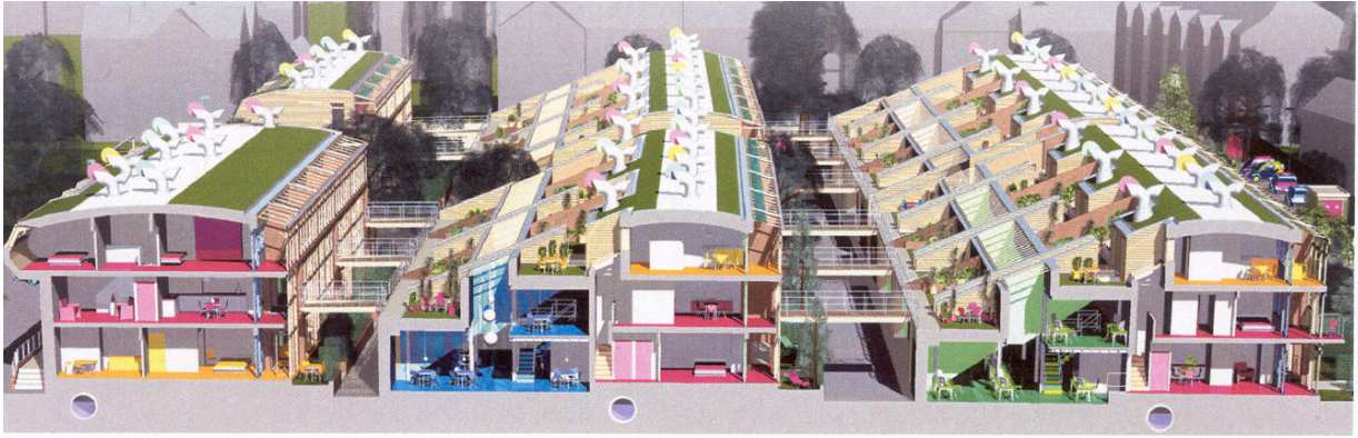
Fig 5 Mezcla de usos y forma de los edificios para el correcto asoleamiento de las viviendas en BEDZED Londres ( Bill Dunster , Architects)., Propuesta de usos mixtos ,
