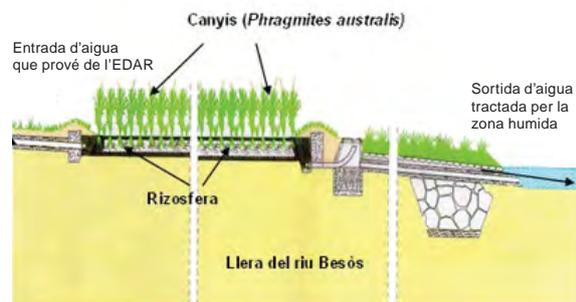
fig. 3.20 Esquema funcionamiento wetlands ubicadas sobre laz zonas húmedas
