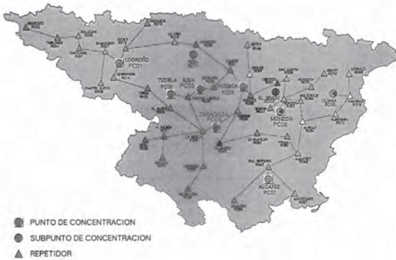
Figura 5. Red primaria de comunicación de radio del SAIH Ebro.
