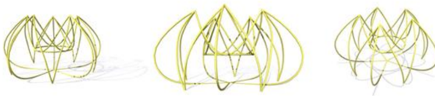
Figura 1. Representación gráfica de la estructura de cañas que forma parte del centro de experimentación rural.
