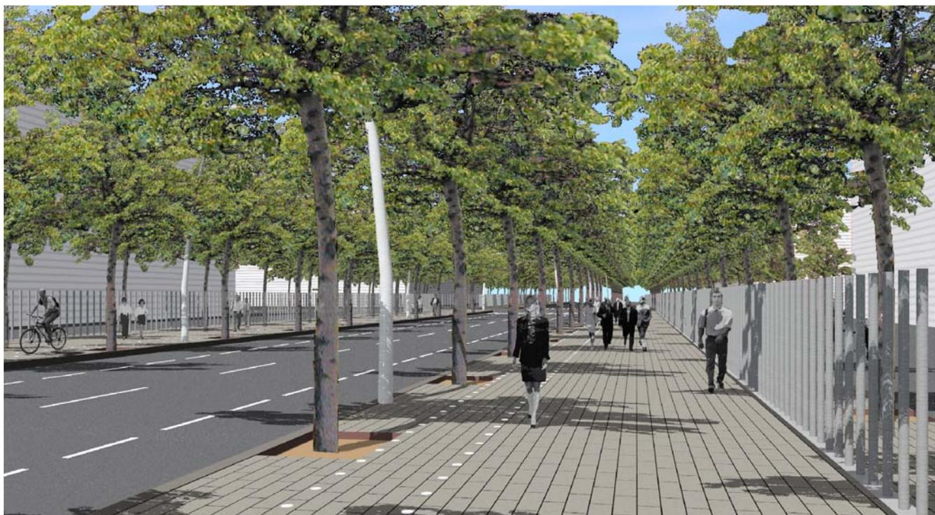
Vial con sección mínima, calzada de dos carriles y dos hileras de aparcamiento, aceras con carril bici incorporado, arbolado de alineación como estructura vertical básica y en los límites de las parcelas como estructura vertical que, junto con la unificación de las vallas, forman la identidad de calidad.
