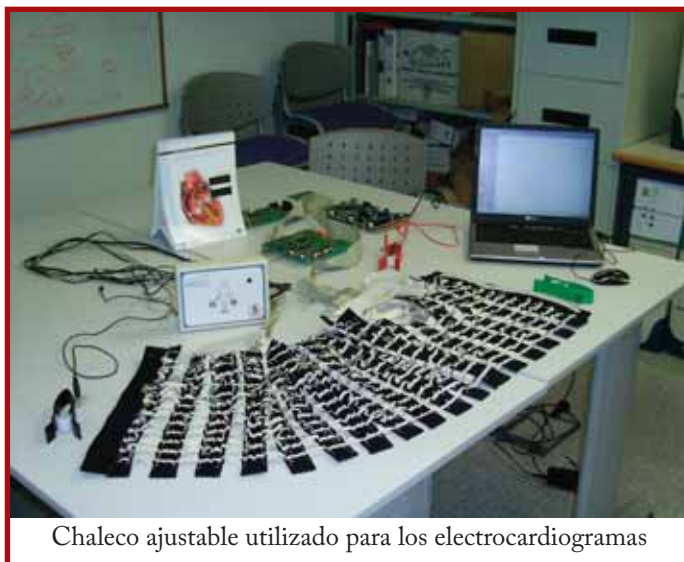
Disposición de los 67 electrodos con la técnica BSPM
