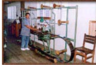
Tensionado y afilado de sierras de banda.
