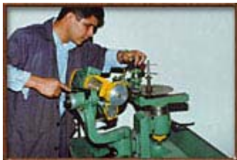
Afilado de dientes de carbide en sierras circulares
