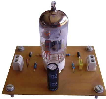
En este artículo vamos a retrotraernos al pasado y construiremos paso a paso un receptor basado en las válvulas de vacío y aprovecharemos esta circunstancia para introducir someramente la descripción y el funcionamiento de estos dispositivos electrónicos, que hicieron de trampolín hasta la llegada de los dispositivos electrónicos semiconductores.
