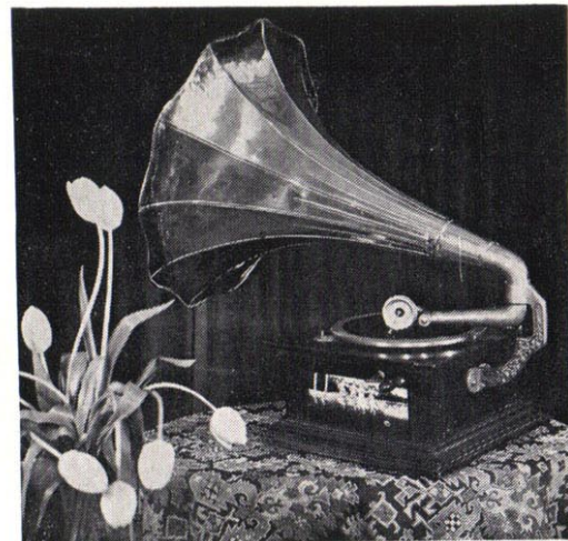
Los gramófonos polifonos de aquella época tenían a veces cuernos o bocinas de gran volumen para obtener una mejor reproducción del sonido.
