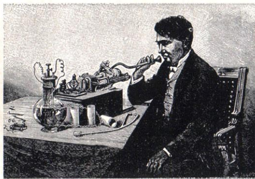
Thomas Alva Edison hablando en su fonógrafo. En este aparato se graban las vibraciones de sonido en un cilindro de cera. Los cambios de profundidad del surco hacen mover el disco de vibración, lo que permite oír el sonido. A la izquierda se ve un elemento de ácido crómico que sirve para accionar el electro-motor del aparato.
