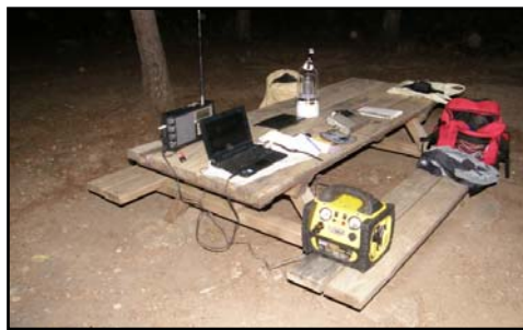
Vista del voluminoso equipo empleado en la salida a Portaceli 28/08/2010. Podemos observar la Satellit 500, la Sangean ATS909, el ordenador portátil con su conexión a la radio y el muy útil equipo de energía portátil a 12 V - 230 V ~
